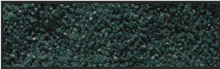
Lors de l'étape n°3 et 4 nous obtenons des granules Nylo® par le broyage fin des filets. Le Nylo® est du polyamide 6 régénéré.
